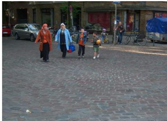
Die Fahrbahnkante ist auf Gehsteigniveau heraufgezogen, die Pflasterung der Kreuzung ist kreisförmig und gibt dadurch einen Kreisverkehr vor. Fußgänger überqueren die Kreuzung als Platz.
